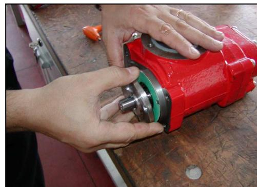
La fase di sostituzione della boccia viene rimpiazzata dall'introduzione dello "Speedi sleeve".
